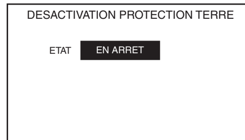
Figure 49 – Écran d'arrêt de désactivation protection terre
